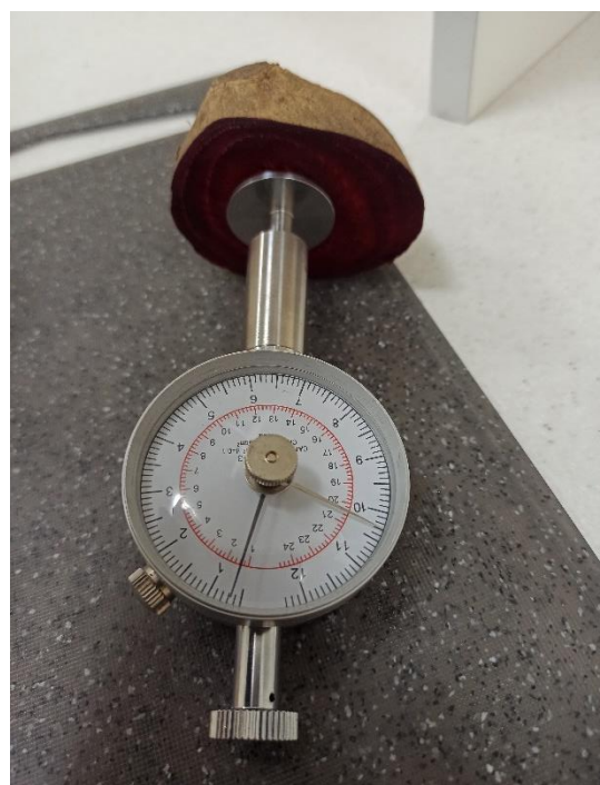
Рисунок 2.3 – Підготовка зразка столового буряка та визначення твердості коренеплоду пенетрометром
