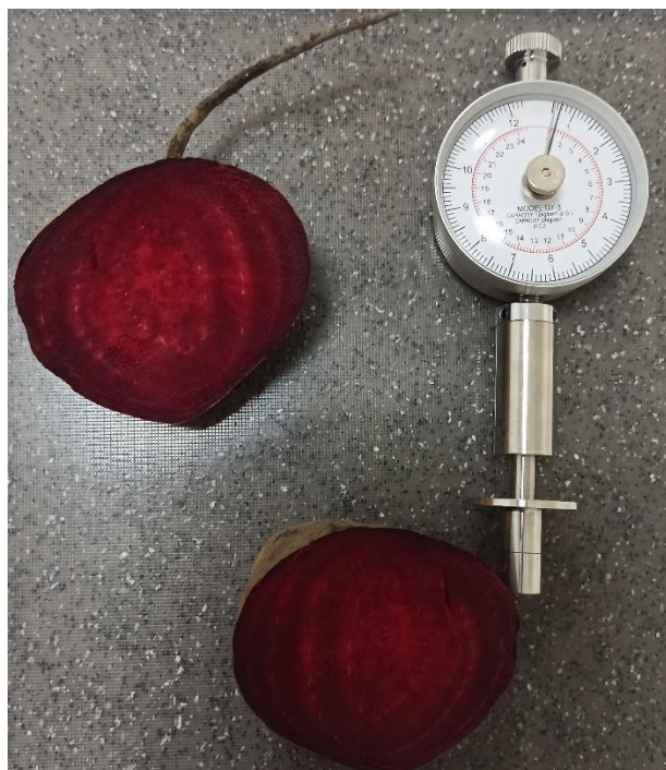
Рисунок 2.3 – Підготовка зразка столового буряка та визначення твердості коренеплоду пенетрометром
