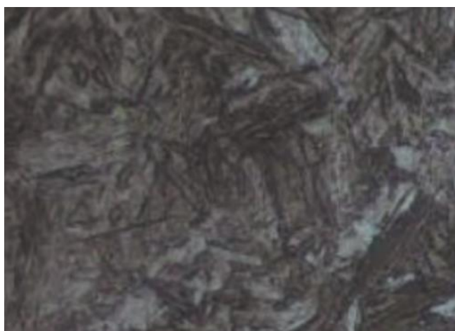
Рисунок 3.4 – Мікроструктура сталі 13X11H2B2МФ після гартування. \times 500 .
