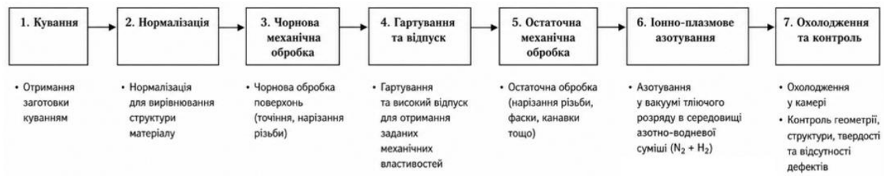
Рисунок 2.6 – Схема послідовності технологічного процесу азотування деталей
