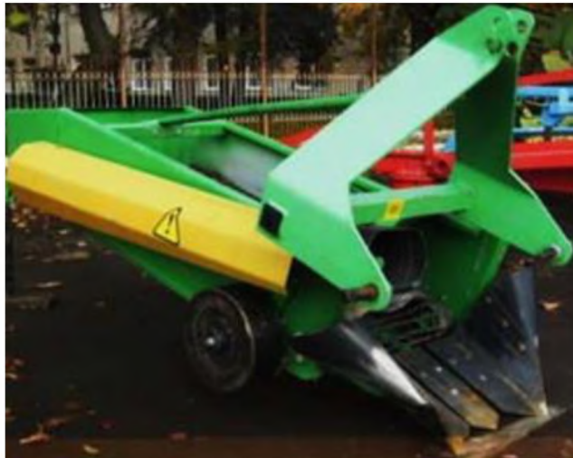
Рисунок 1.4 – Картоплекопач КН-1, з прутковим транспортером і приводом від опорного колеса
