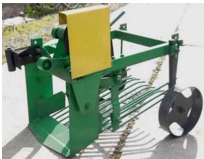
Рисунок 1.3 – Картоплекопач КМГ-1 для агрегування з мототракторами
