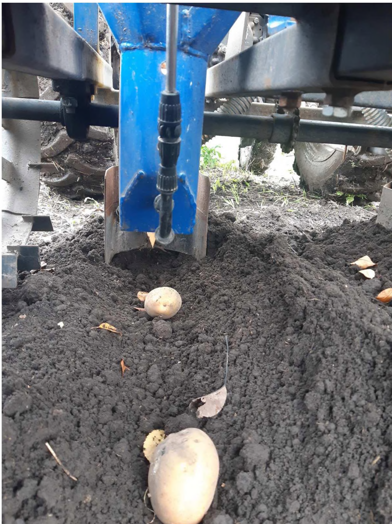
Рисунок 3.2 Фото розміщення розпилювачів на картоплесаджалці-протруювачі
