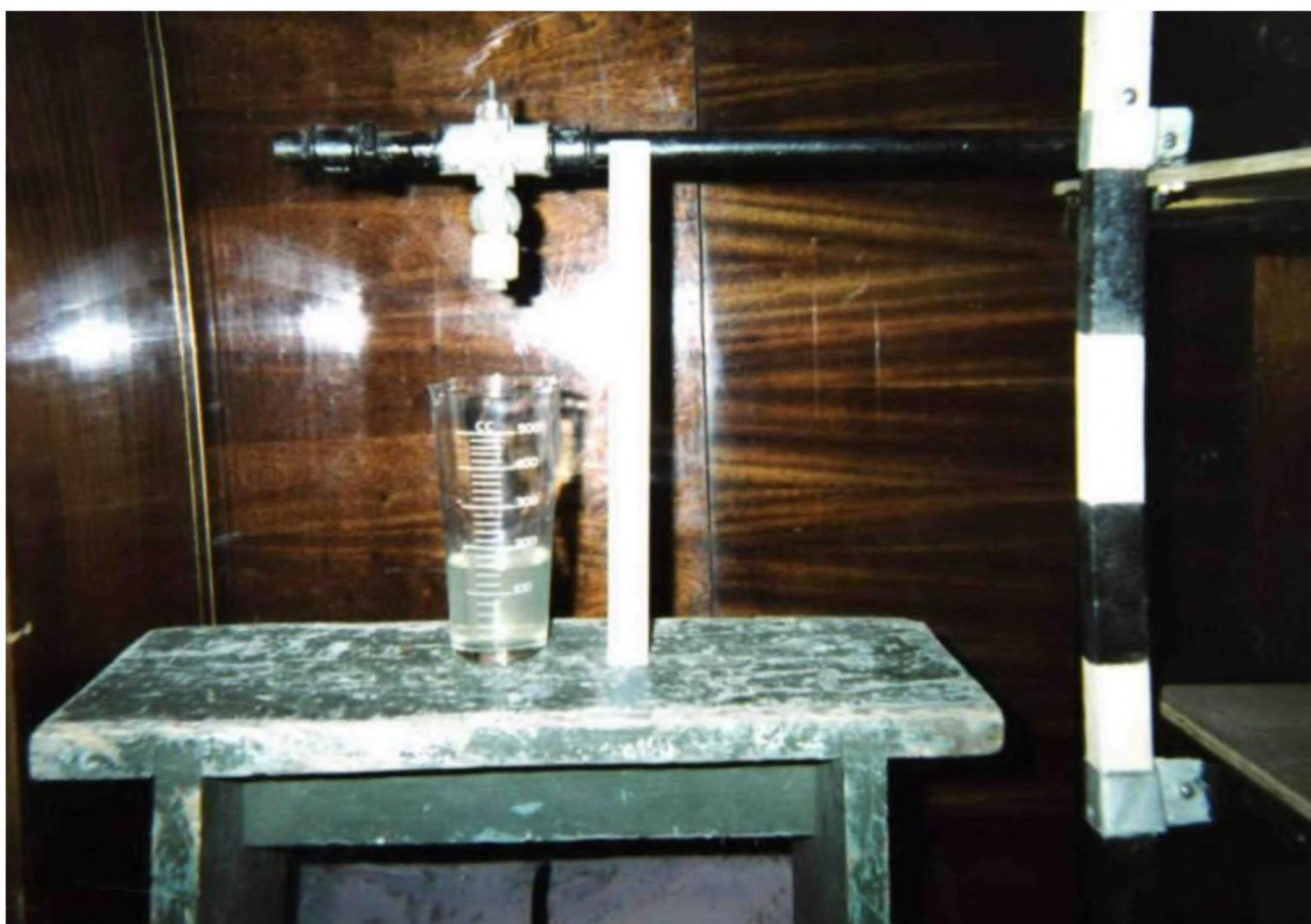
Рисунок 3.4 Фото установки для дослідження витрати рідини розпилювачем
