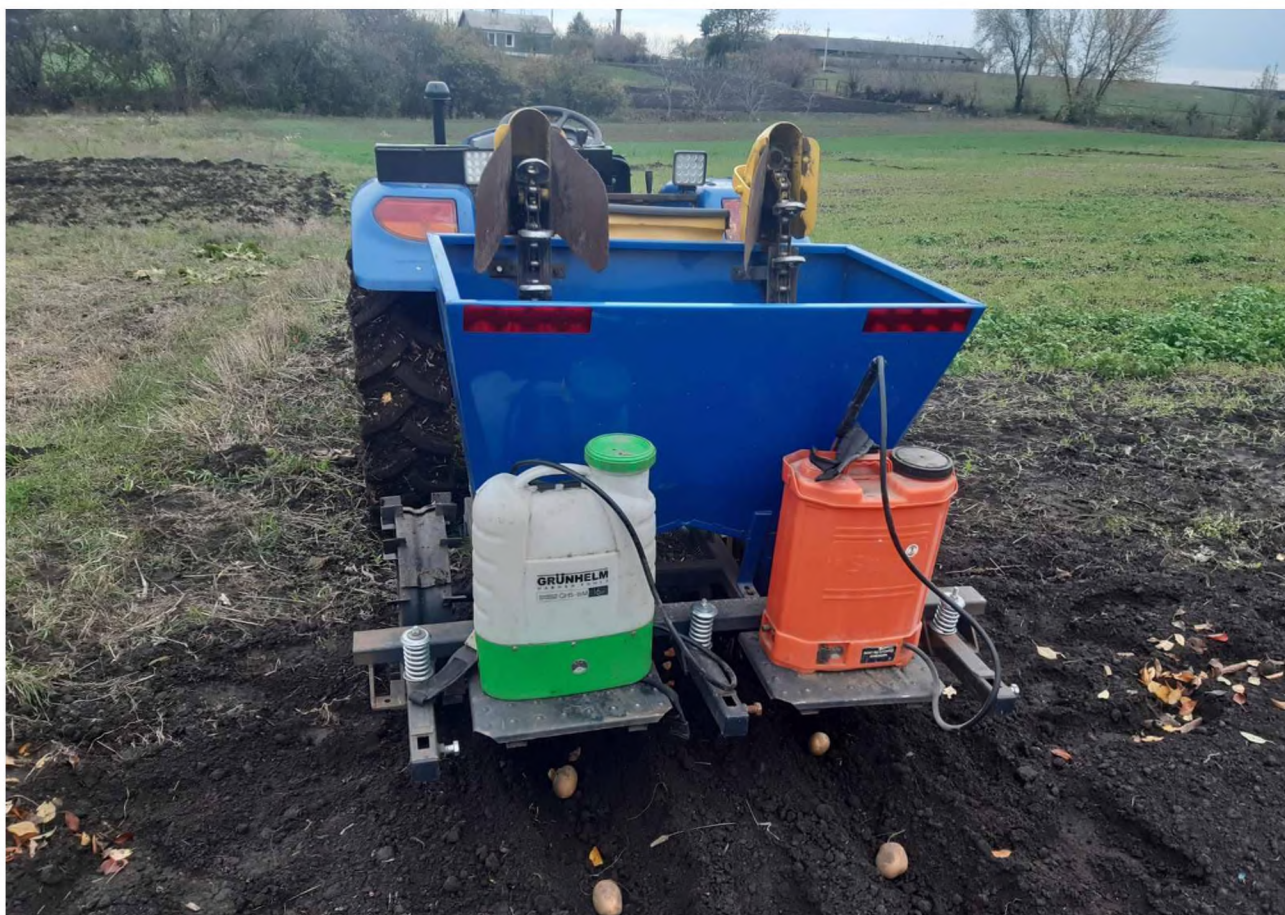
Рисунок 3.1 Загальний вигляд лабораторної установки картоплесаджалки-протруювача
