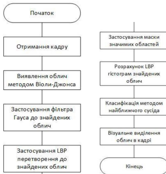
Рисунок 2.1 – Узагальнена блок-схема алгоритму обробки кадрів відеопотоку
