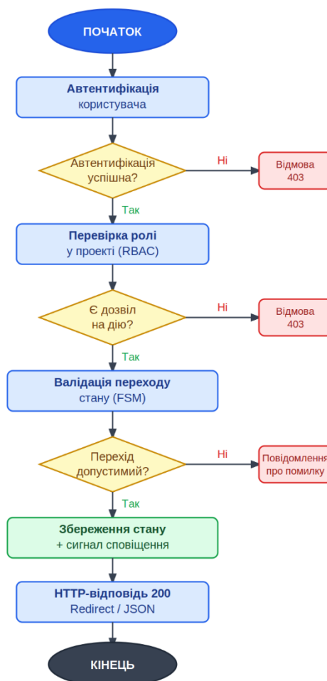
Рисунок 2.1 – Блок-схема алгоритму обробки запиту
