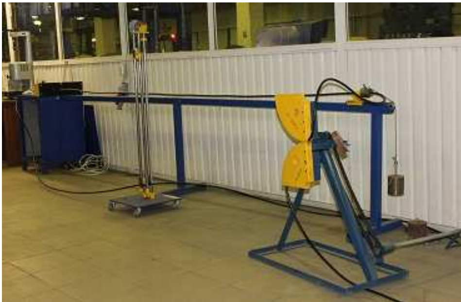
Рис. 5. Установка для випробування на стійкість до осьового кручення
