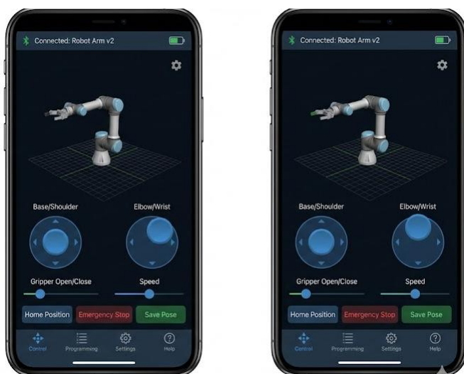
Рисунок 2.10 – Графічний інтерфейс мобільного додатку для керування маніпулятором
