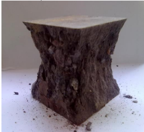
Рисунок 3.1 – Характер руйнування бетонного зразка при стиску
