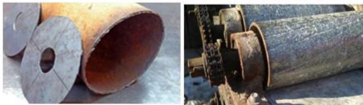
Рисунок. 3.4 – Заготовка для виготовлення плющильного апарата, та плющильний апарат
