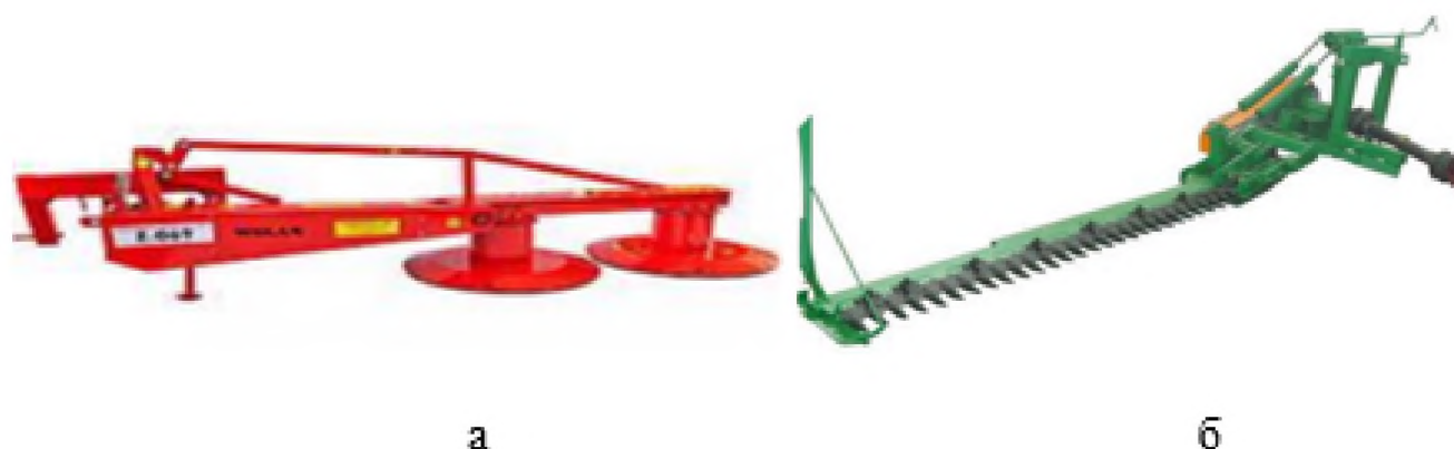
Рисунок 1.3 – Навісні косарки: а) роторна Wirax Z-169 / 069, б) сегментно-пальцева КПО-2,1
