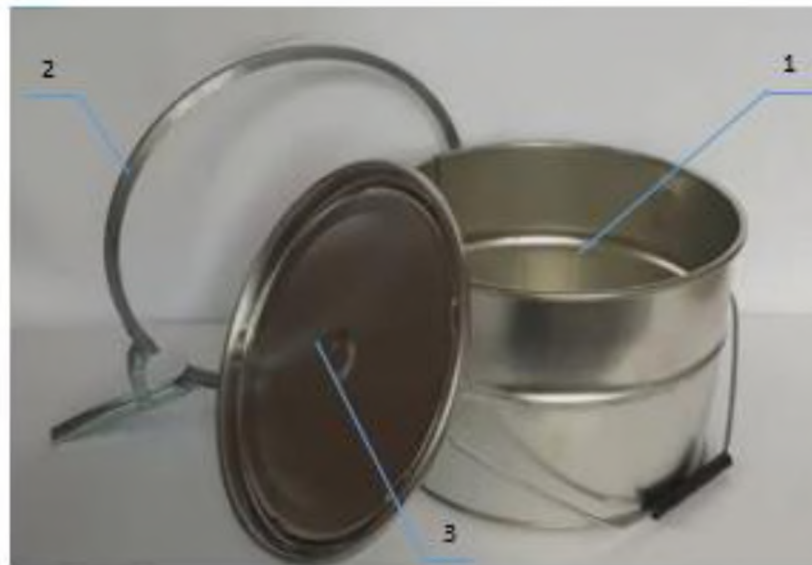
Рисунок 3.1 – Ємкість для відбору зразків: 1 – ємкість, 2 – кришка, 3 – застібка
