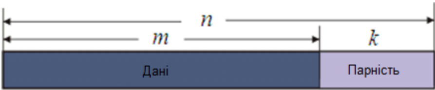
Рисунок 8.4 – Структура кодового слова R-S
