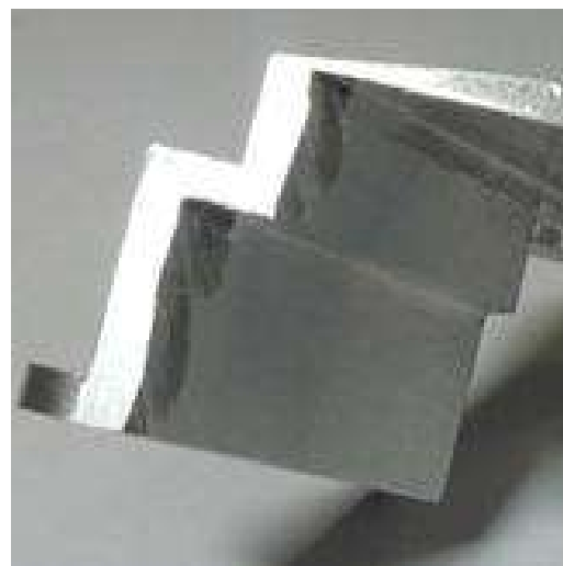
Рисунок 4.1 – Дефекти (зарізи) під час оброблення першої деталі «Кронштейн»
