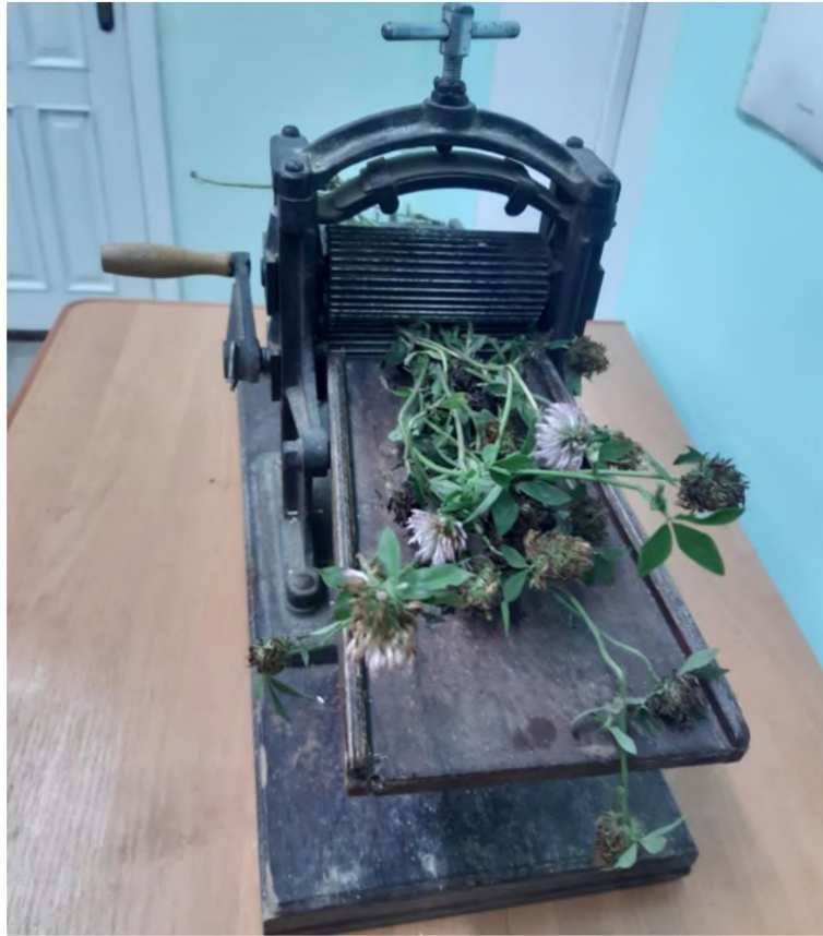
Рисунок 3.2 Лабораторна установка із плющильними вальцями
