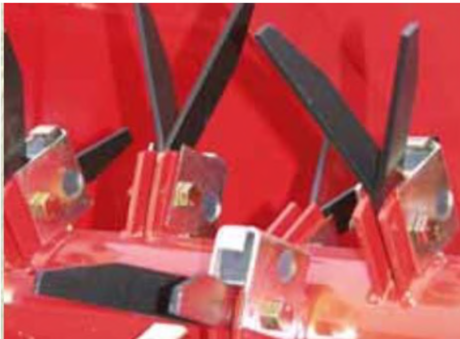
Рисунок 1.5 Шарнірне кріплення V-подібних бітерів кондиціонерів фірми PÖTTINGER
