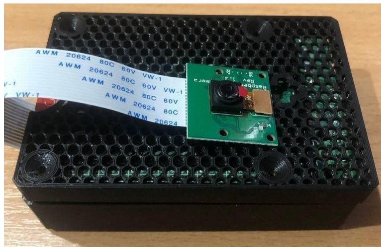
Рисунок 3.6 – Зібраний макет системи ідентифікації об'єктів (виробів подвійного призначення) на конвеєрній лінії
