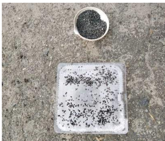
Рисунок 7.8 – Імітація посипаного слизького дорожнього покриття нагрітим кам'яним матеріалом
