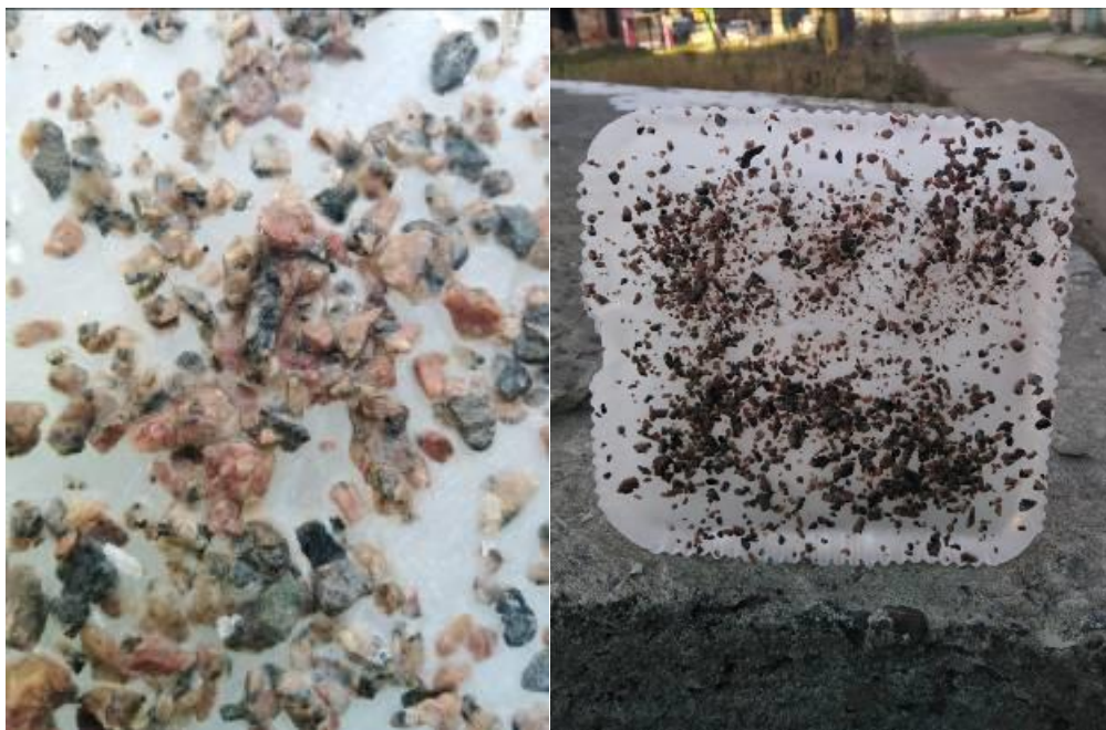
Рисунок 7.9 – Примерзання нагрітого матеріалу до слизького покриття
