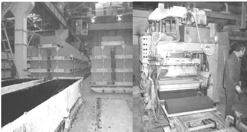
Рис. 5.3. Процес формування силікатобетонних виробів
