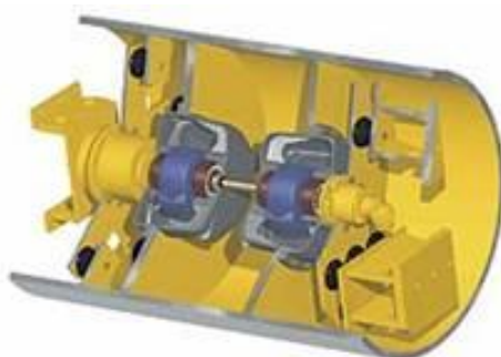
Рис. 9.21. Пристрій механізму вібрації вальця
