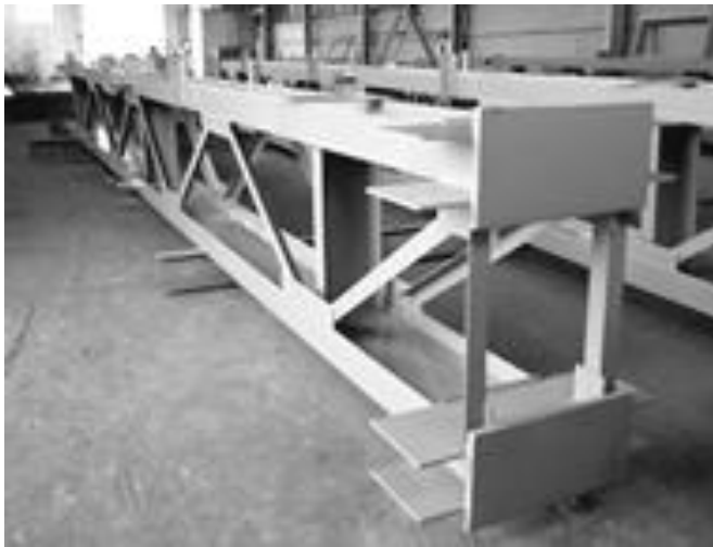
Рис. 6.2. Конструкція перекриття металургійного цеху
