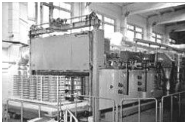
Рис. 7.2. Тунельна піч для випалу керамічних виробів
