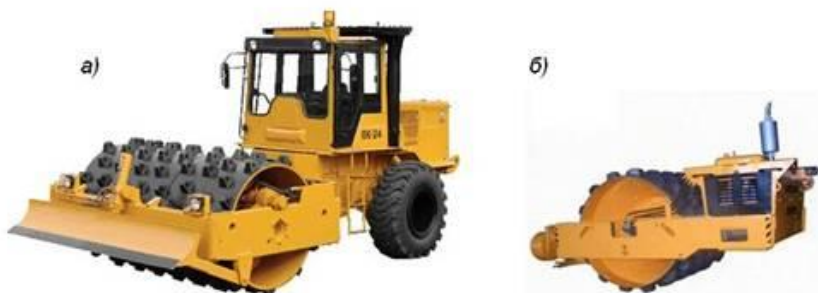
Рис. 9.20. Коток з кулачковим вальцем (грунтовий): а) самохідний, б) причіпний
