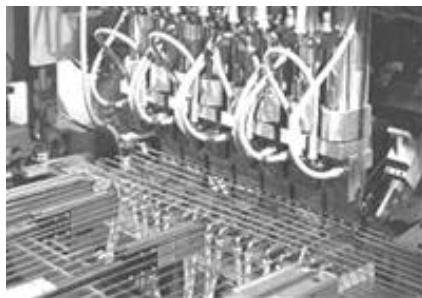
Рис. 4.2. Виготовлення арматурної сітки методом контактного зварювання
