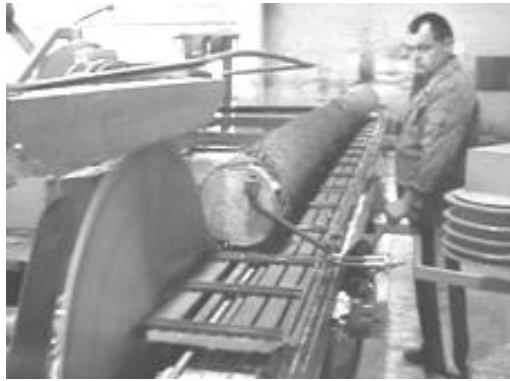
Рис. 8.5. Розпилювання колоди на вертикальному циркулярному верстаті
