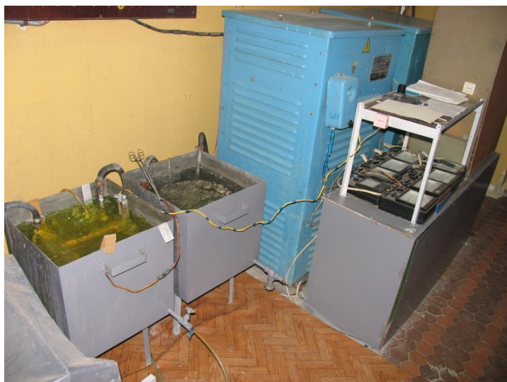
Рисунок 2.10 – Загальний вигляд установки для ПЕО
