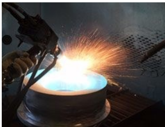
Рисунок 2.1 – Загальний вигляд методом електродугового напилення
