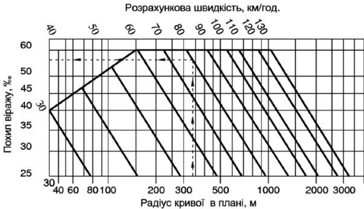
Рисунок 2.4 – Номограма для визначення поперечного похилу віражу.
