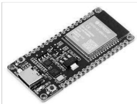
Рисунок 1.6 – Мікроконтролер серії ESP32 з роз'ємом USB Type-c [10]
