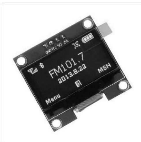
Рисунок 2.6 – OLED Дисплей 128x64 [19]
