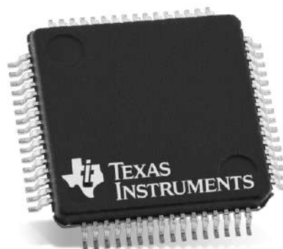
Рисунок 1.5 – Мікроконтролер 16-бітної серії MSP430 [9]
