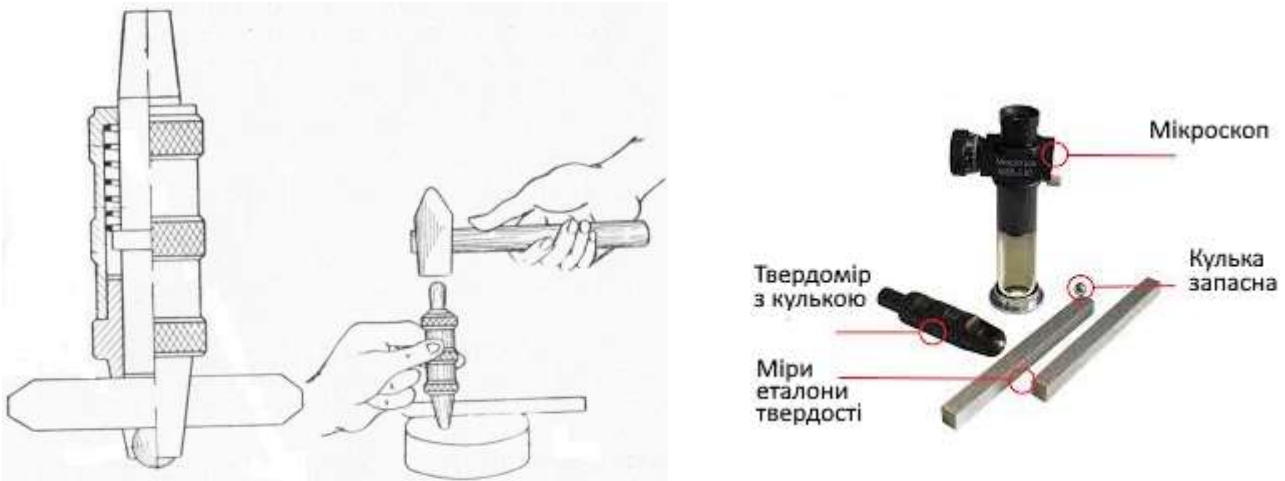
Рисунок 1.1 – Метод та твердомір Польді вимірювання твердості металів
