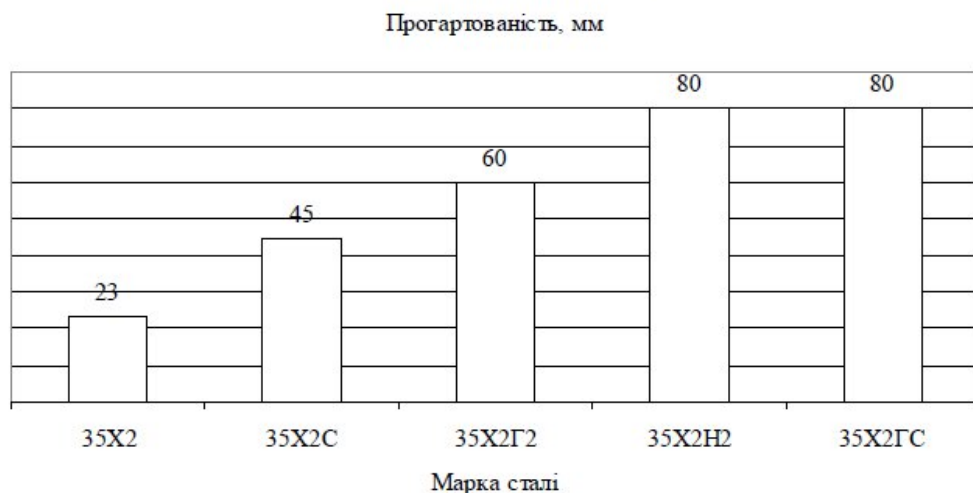
Рисунок 13.5 Вплив легування на прогартованість сталей
