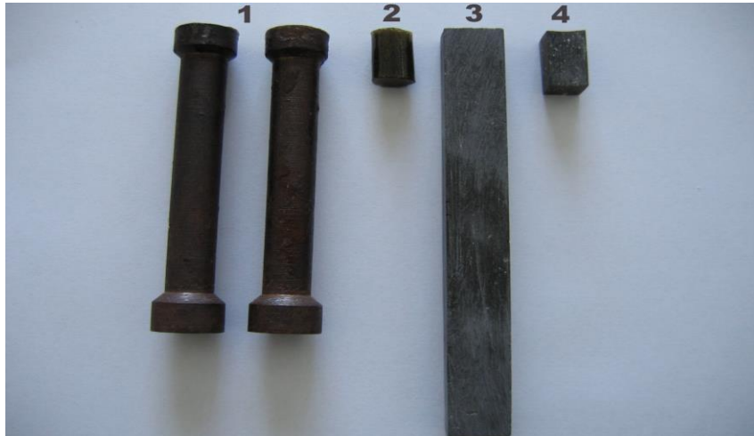
Рисунок 2.3 – Вигляд зразків для досліджень: 1 – адгезійної міцності; 2 – міцності на стиск; 3 – теплостійкості; 4 – зносостійкості
