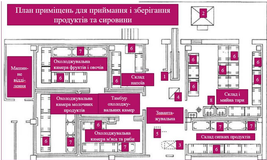
Рис. 4.3 – План приміщень для приймання і зберігання продуктів [2]: 1 – стрічковий транспортер; 2 – ваги; 3 – вантажний візок; 4 – товарні ваги; 5 – колісний піддон; 6 – підтоварник; 7 – стелажі; 8 – мийна ванна
