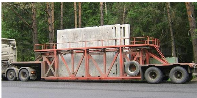
Рисунок 4.1 Спеціалізований автомобіль для перевезення з/б виробів
