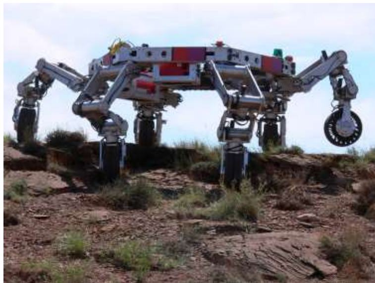
Рисунок 1.6 – Колісно-крокуючий моноприводний робот «ATHLETE»
