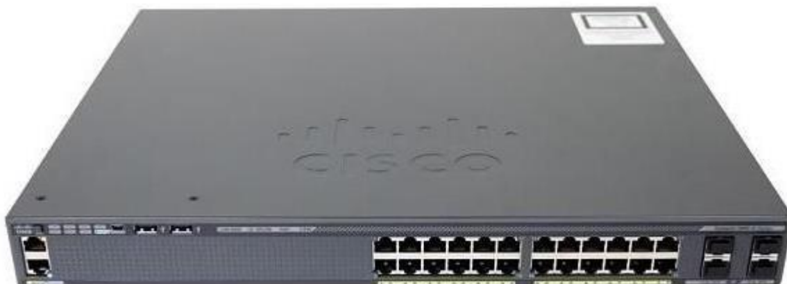
Рисунок 2.5 – Комутатор 3 рівня Cisco Catalyst 2960-X-24 [10]
