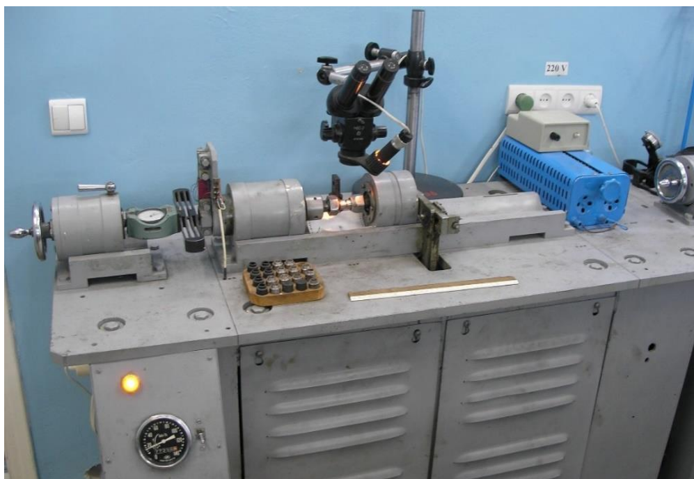
Рисунок 3.2 – Зовнішній вигляд установки МФК-1 для випробувань на фретинг-корозію
