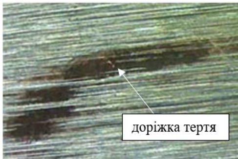
Рисунок 4.4 – Ознаки зношування при навантаженнях в 20 МПа (а, б). \times 28
