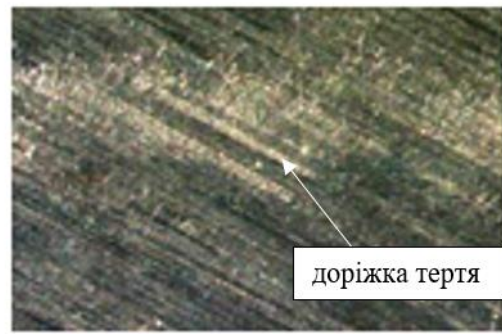
Рисунок 4.4 – Ознаки зношування при навантаженнях в 20 МПа (а, б). \times 28
