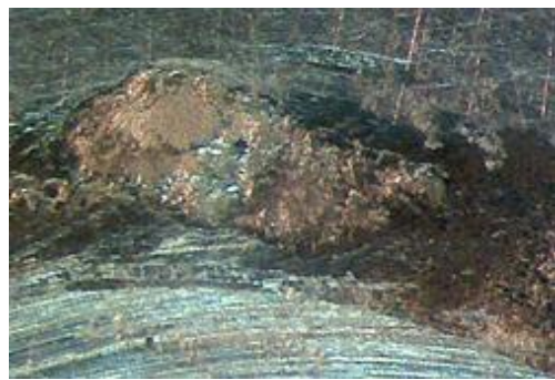
Рисунок 4.7 – Сколи на Grade 23 з вакуумно-дуговим покриттям при навантаженні 30 Мпа. а \times 80 , б \times 50
