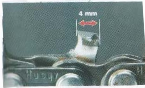
Рис. 3.9. Загострений зуб до висоти 4 мм
