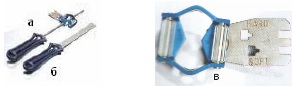
Рис. 3.5. Загострювальні інструменти: а – круглий напилек; б – плоский напилек; в – шаблон
