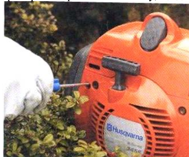
Рис. 2.12. Регулювання холостого ходу
