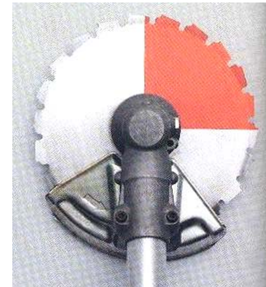
Рис. 2.13. Сектор віддачі при зрізуванні стовбурів діаметром більше 3 см
