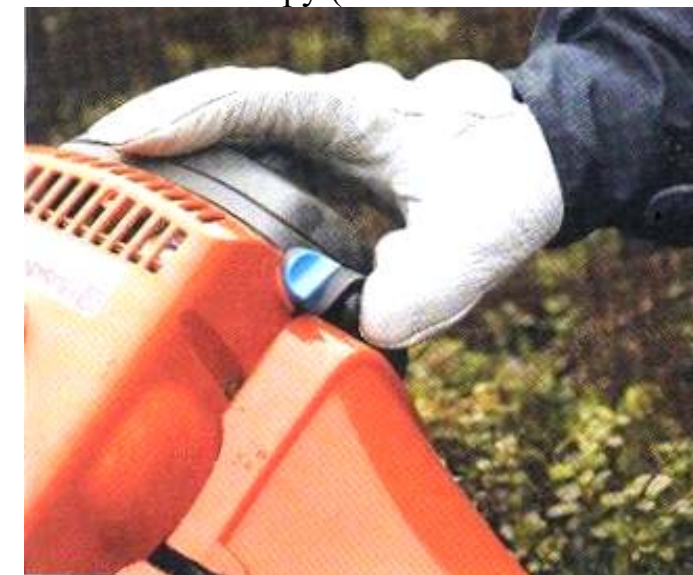
Рис. 2.10. Запуск холодного двигуна
