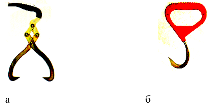
Рис. 2.7. Ручні інструменти для повертання, піднімання та переміщення колод: а – грейферний захоплювач; б – гак
