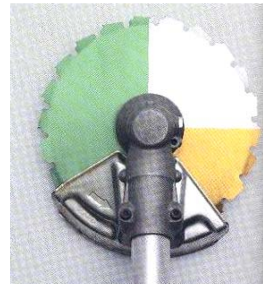
Рис. 2.14. Сектори оптимального зрізування стовбурів діаметром більше 3 см
