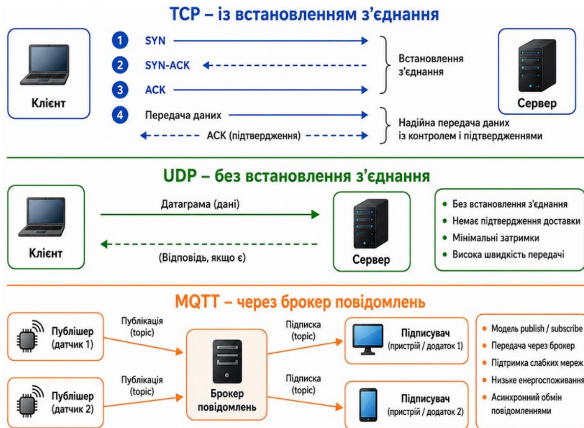
Рисунок 1.1 – Принципи роботи протоколів TCP, UDP та MQTT [9]
