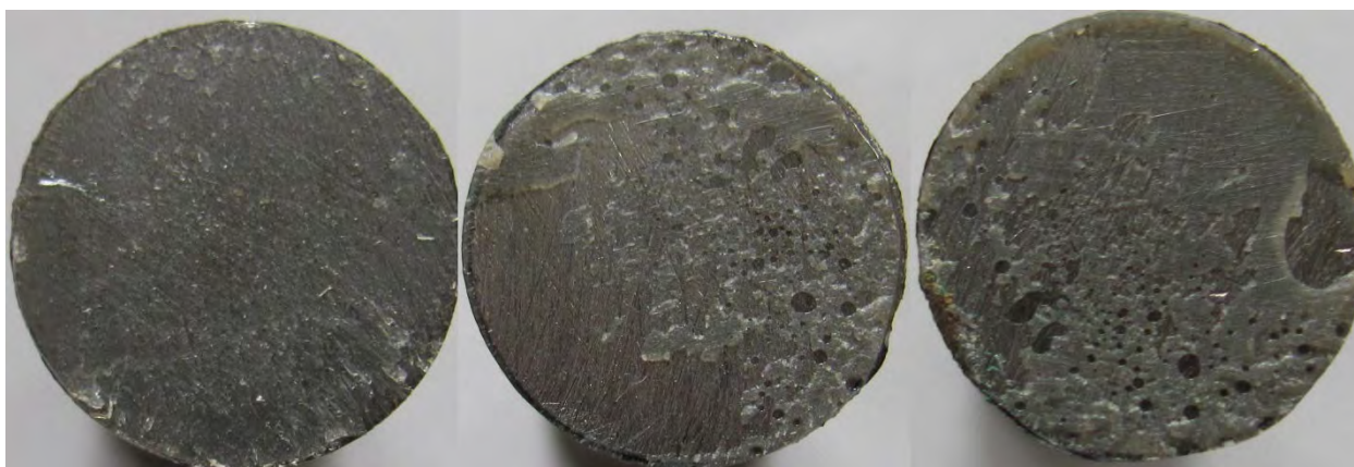
Рисунок 3.4 – Загальний вигляд поверхні після досліджень на адгезійну міцність епоксикомпозитів, що містять:
