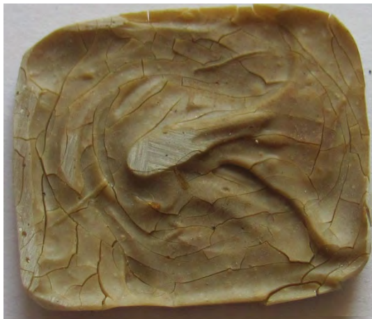
Рисунок 3.6 – Загальний вигляд епоксикомпозитних зразків після екстрагування з вмістом крейди в кількості: а – 60 мас.ч., б – 80 мас.ч.
