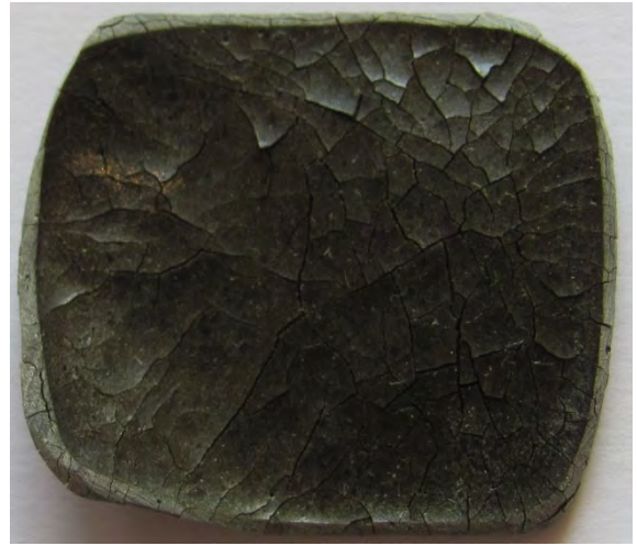
Рисунок 3.5 – Загальний вигляд епоксикомпозитних зразків після екстрагування з вмістом цементу в кількості: а – 60 мас.ч., б – 80 мас.ч.
