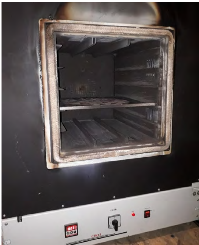
Рисунок 2.1 – Камера сушильної шафи з аеродинамічним перемішуванням потоків повітря моделі СНОЛ 400
