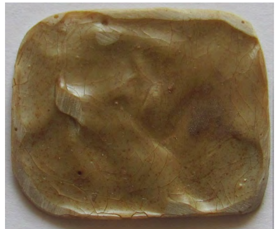
Рисунок 3.6 – Загальний вигляд епоксикомпозитних зразків після екстрагування з вмістом крейди в кількості: а – 60 мас.ч., б – 80 мас.ч.
