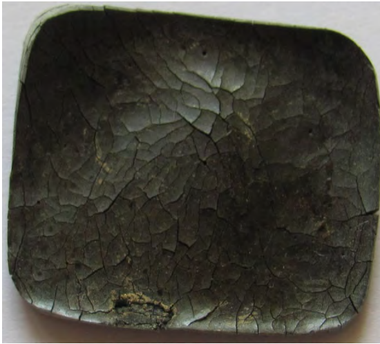
Рисунок 3.5 – Загальний вигляд епоксикомпозитних зразків після екстрагування з вмістом цементу в кількості: а – 60 мас.ч., б – 80 мас.ч.
