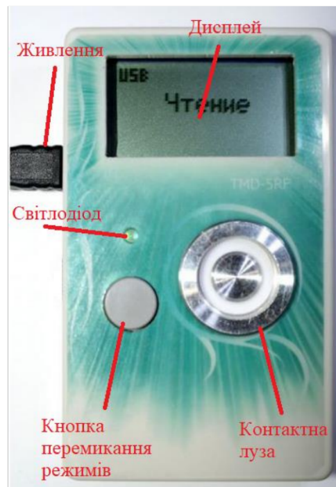
Рисунок 2.1 – Контактний дублікатор домофонних ключів [7]
