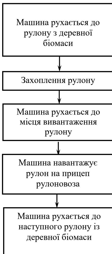
Рисунок 2.1 – Структурна схема машини для навантаження рулонів з деревної біомаси
