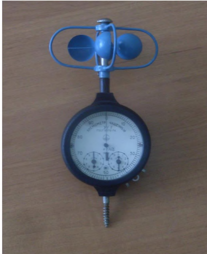
Рисунок 3.1 Чашковий анемометра МС-13
