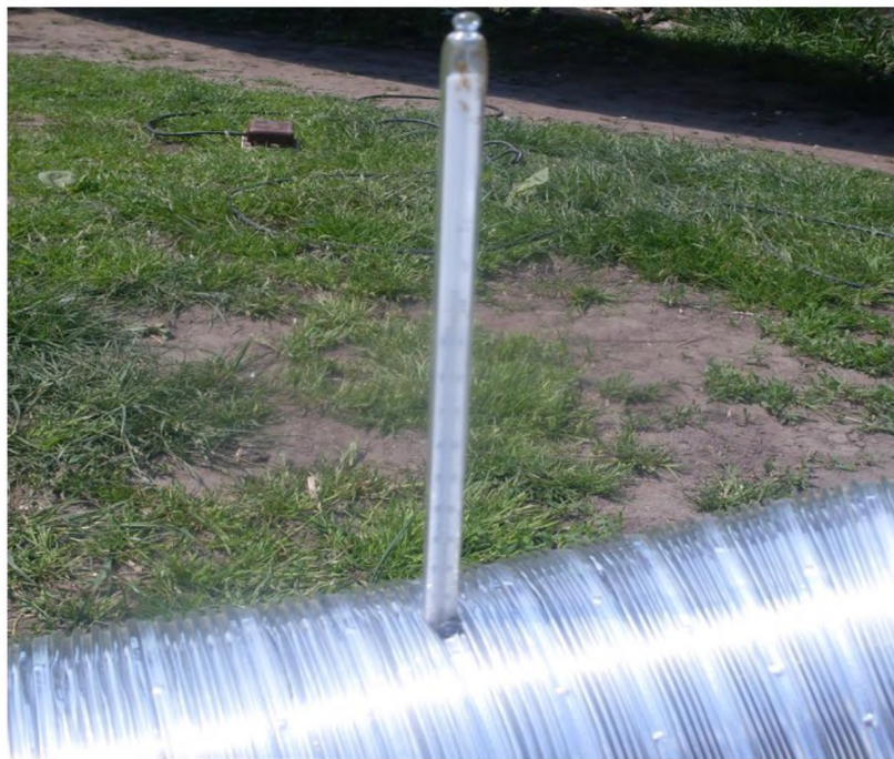
Рисунок 3.3 Вимірювання температури сушильного агенту у колектору за допомогою ртутного термометра
