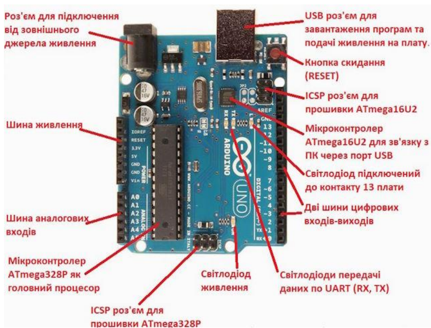
Рисунок 2.2 – Елементи плати Arduino Uno [33]
