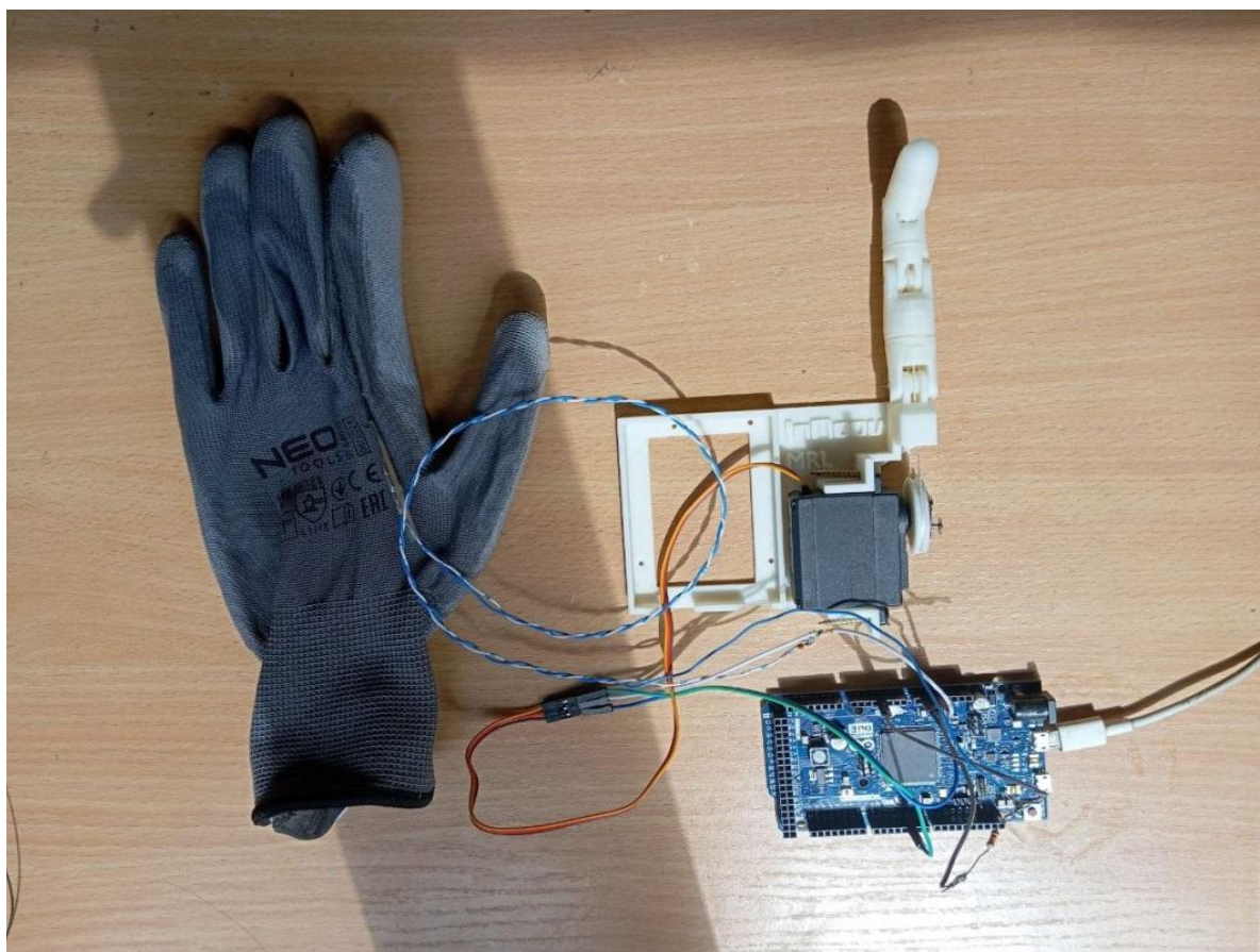
Рисунок 3.8 – Вигляд імітатора штучного пальця та модуль керування у вигляді рукавиці з сенсором.
