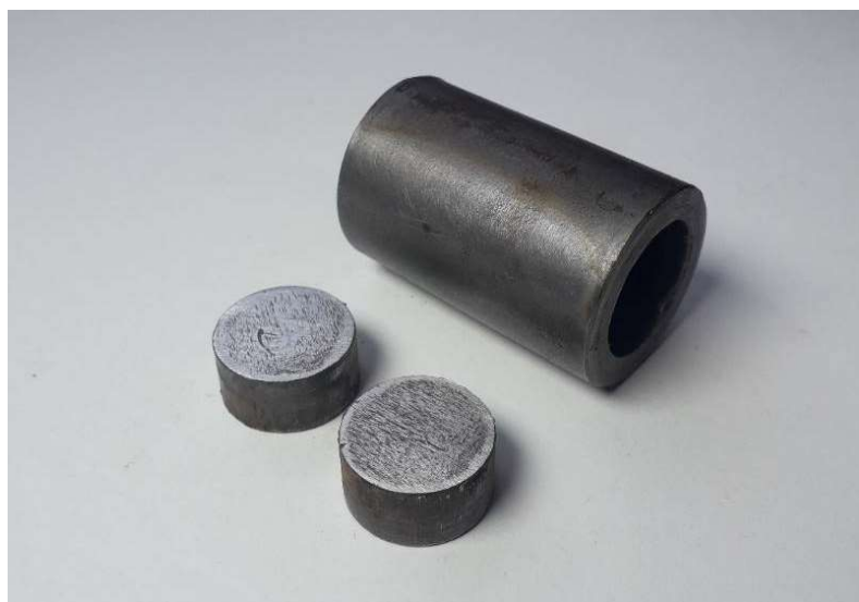
Рисунок 2.4 – Загальний вигляд прес-форми для виготовлення циліндричних зразків
