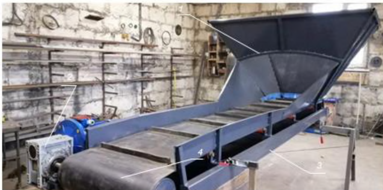
Загальний вигляд дослідної установки: 1 – завантажувальний бункер, 2 – привід, 3 – рама, 4 – вивантажувальна зона
