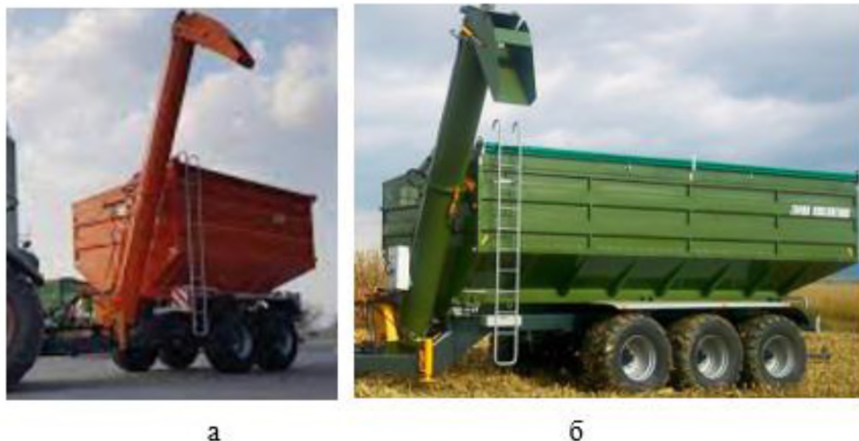
Рисунок 1.1 – Бункери перевантажувачі заводу «Кобзаренка»: а) – ПБН 20 (11,25т, 20м 3 ); б) – ПБН 40 (30т, 40м 3 ).
