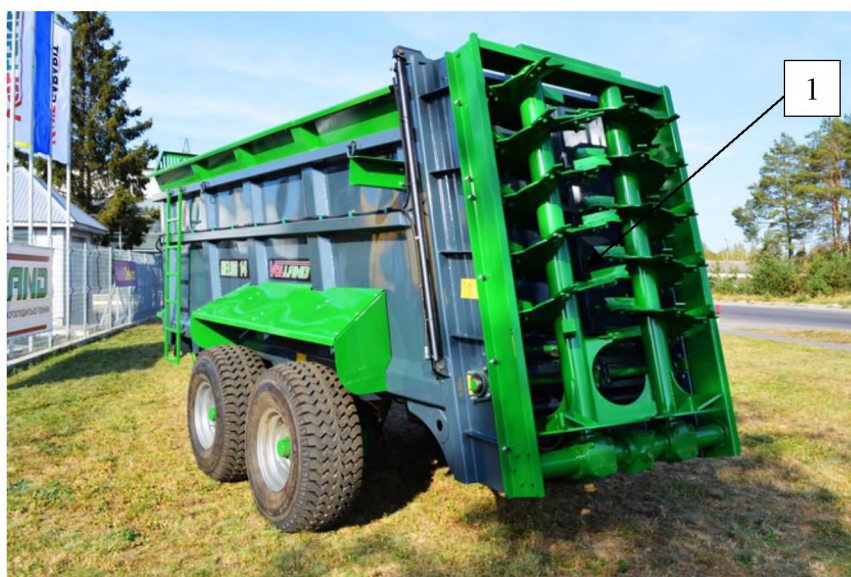
Рисунок 3.2 Причіпний розкидач органічних добрив: 1 – вертикальні гвинтові бітери
