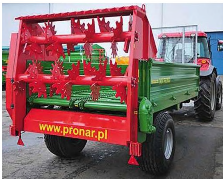
Рисунок 3.3 Горизонтальні шнекові барабани моделі Pronar Heros N161
