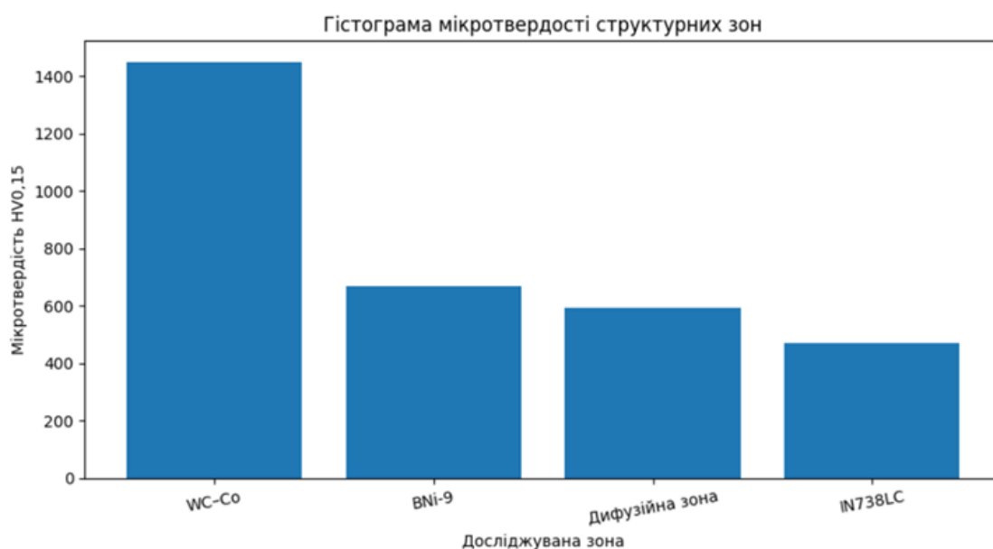
Рисунок 4.4 – Мікротвердість різних ділянок напайки
