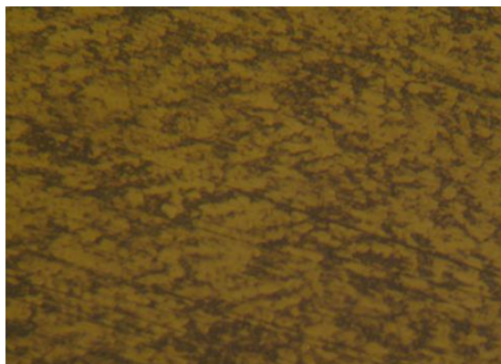
Рисунок 4.3 – Мікроструктура припою BNi-9: а – \times 400 ; б – \times 600
