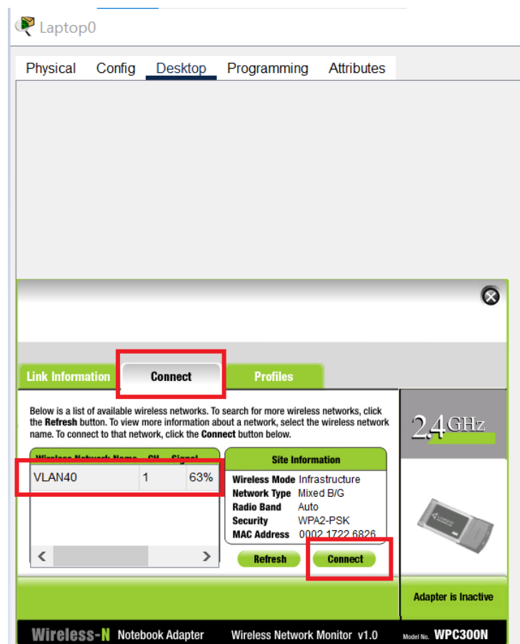
Рисунок 1.29 – Під'єднання до існуючої мережі
