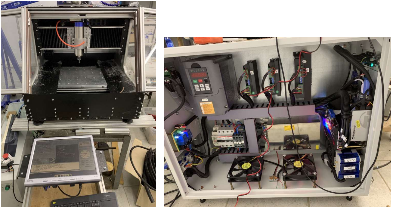
Рисунок 2.1 – 3-х осьовий фрезерний верстат із системою ЧПУ
