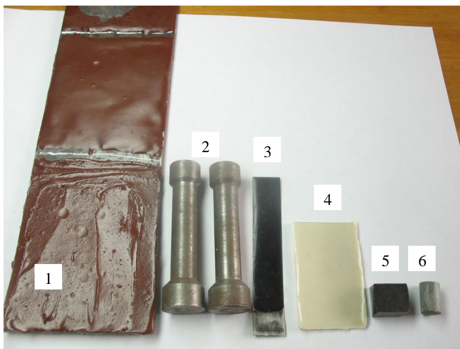
Рисунок 2.1 – Загальний вигляд зразків для фізико-механічних досліджень епоксикомпозитних матеріалів:
