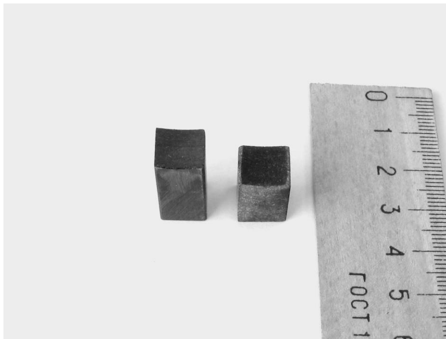
Рисунок 2.6 – Загальний вигляд зразків для триботехнічних досліджень
