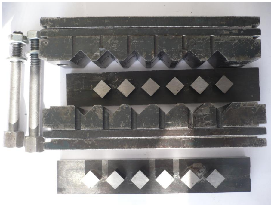
Рисунок 2.7 – Загальний вигляд прес-форми для отримання зразків
