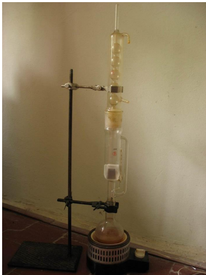
Рисунок 2.4 – Загальний вигляд екстрактора Сокслета в робочому режимі
