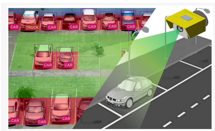
Рисунок 1.7 – Схема роботи системи комп'ютерного зору для автоматичного виявлення зайнятих та вільних паркувальних місць [33]
