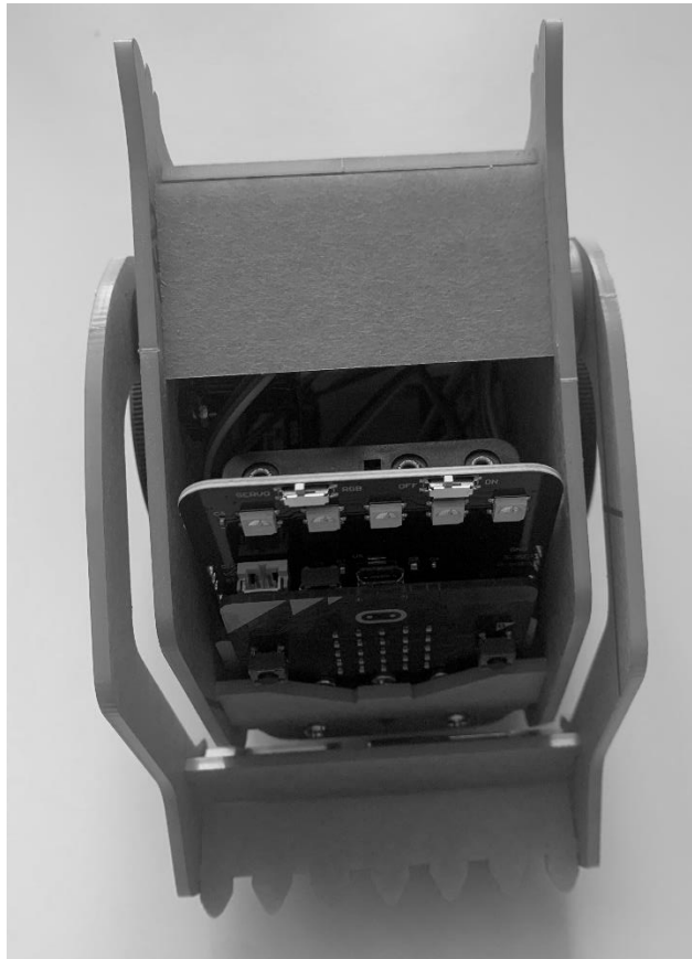
Рисунок 3.21 – Складений міні-робота на основі плати BBC micro:bit
