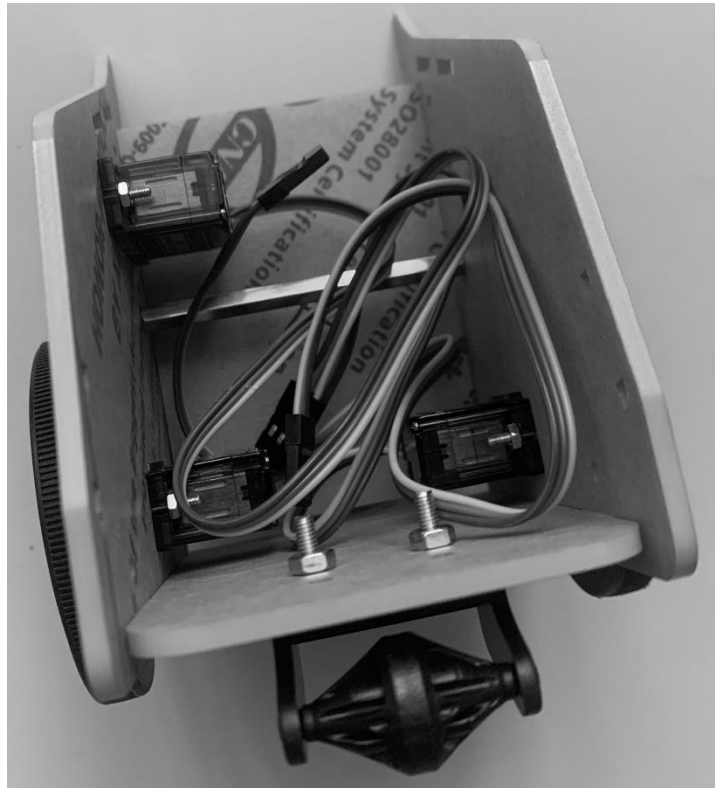
Рисунок 3.12 – З'єднання опорного колеса
