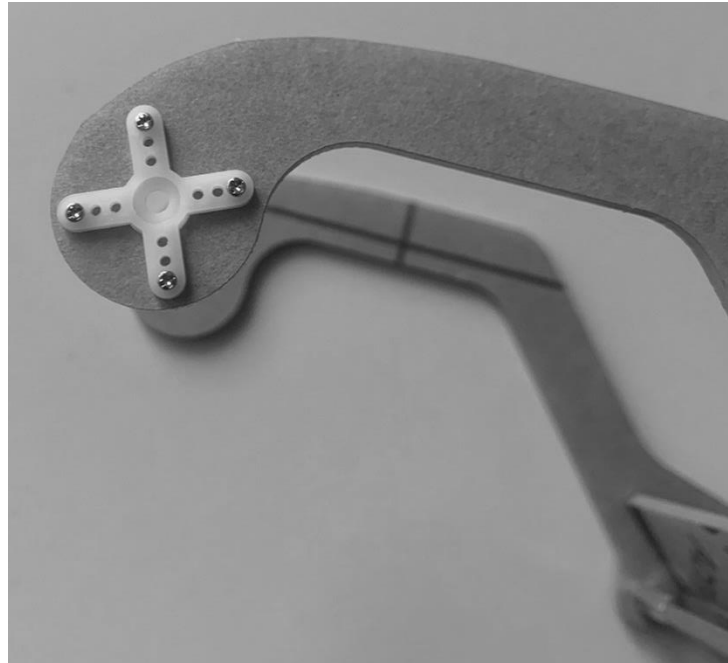
Рисунок 3.14 – Хрестовина для з'єднання із сервоприводом
