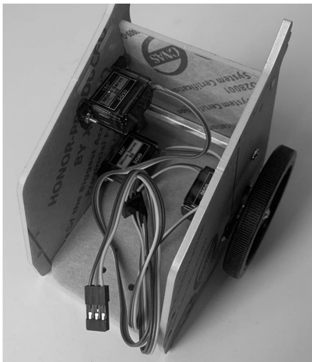
Рисунок 3.11 – З'єднання бокових стінок за допомогою мідної стійки
