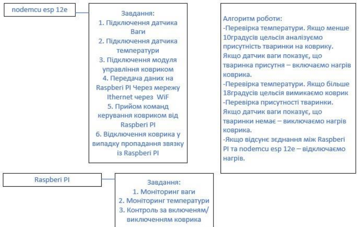
Рисунок 3.1 – Структурно-логічна схема системи автоматизованого обігріву домашніх тварин
