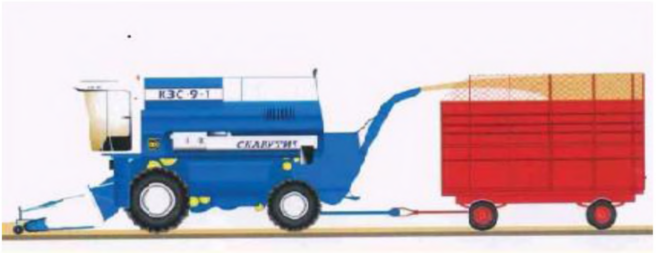
Рисунок 1.2 Потокова технологія збирання соломи
