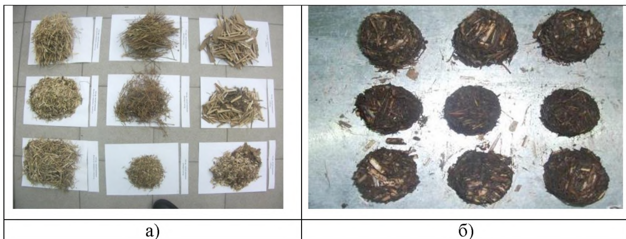
Рисунок 3.4 Моделювання аеробного виробництва твердих органічних добрив у лабораторних умовах: а- подрібнена солома; б- готові добрива
