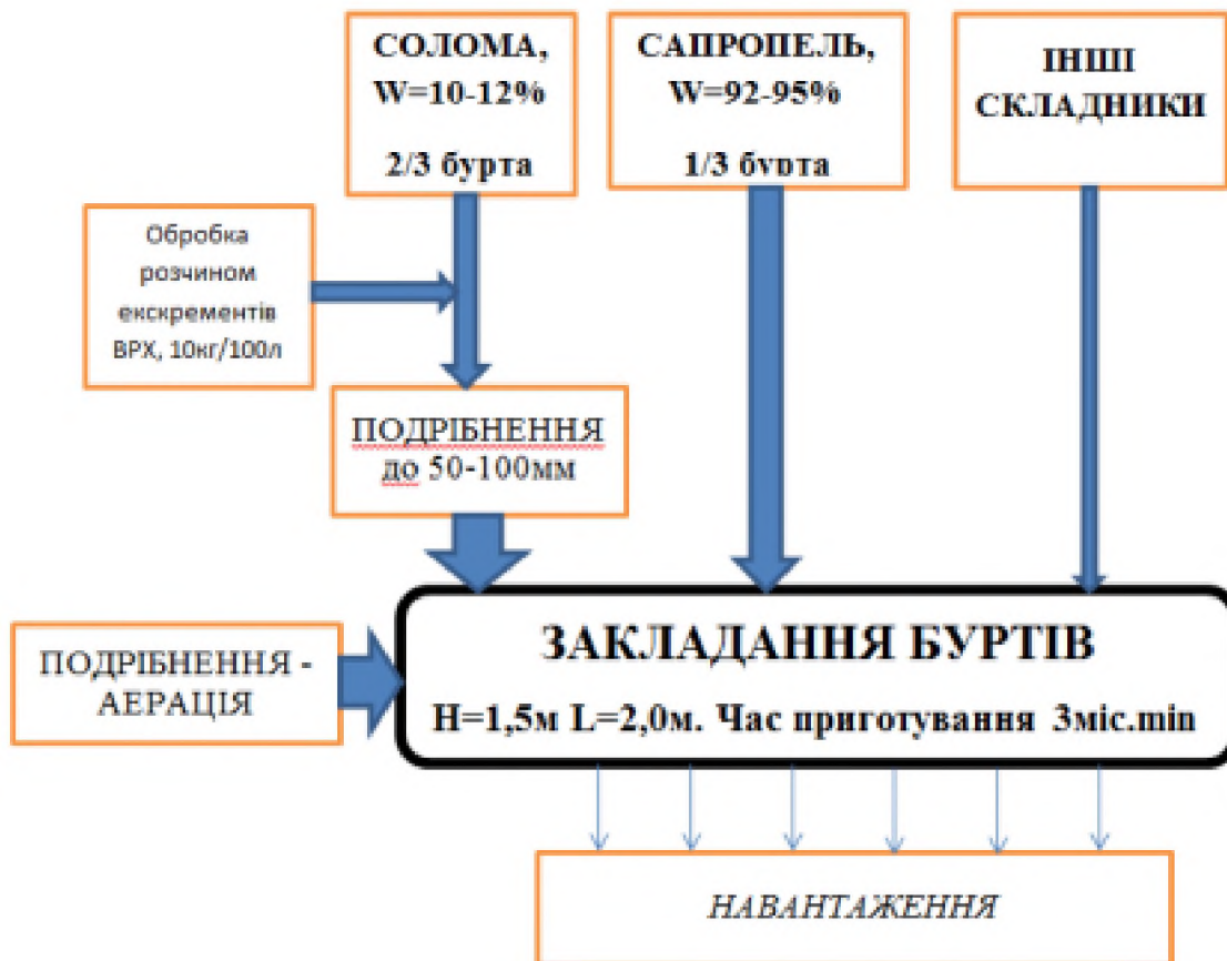
Рисунок 4.3 Схема технологічного процесу аеробного виробництва твердих органічних добрив на основі місцевих сировинних ресурсів природно - кліматичної зони Полісся
