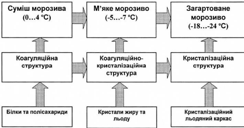
Рисунок 7.2 – Зміни структури морозива впродовж технологічного процесу його виробництва
