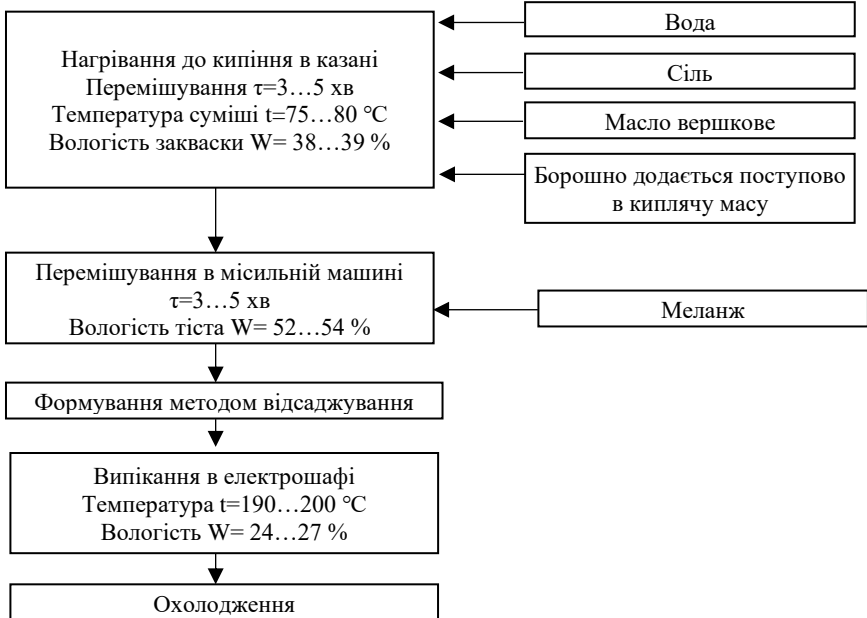
Рисунок 4.8 – Технологічна схема приготування заварного напівфабрикату
