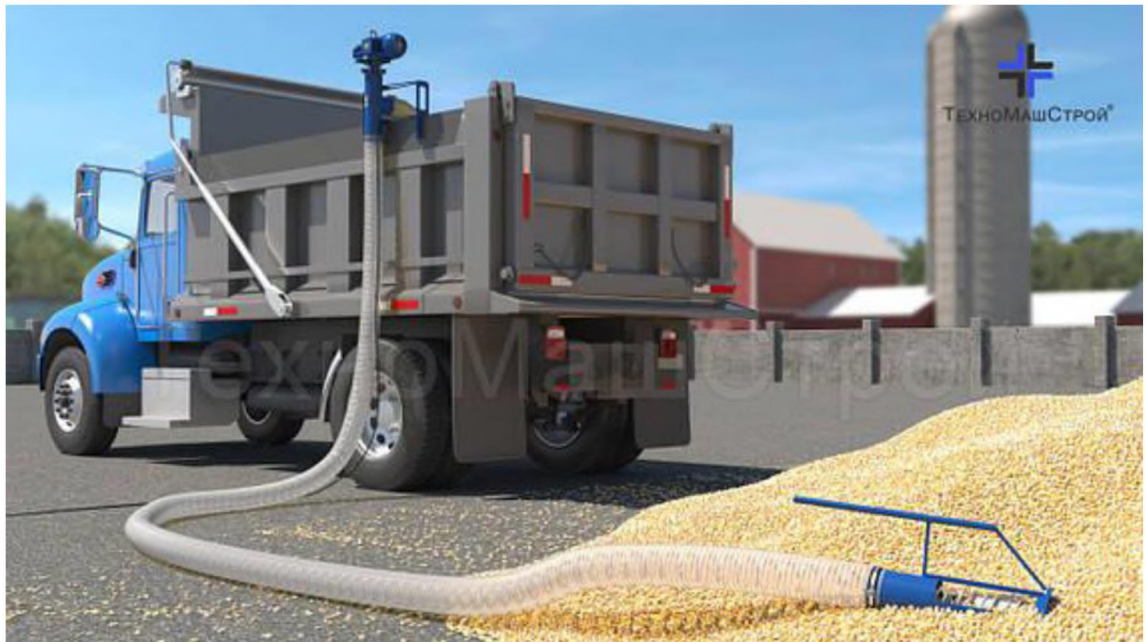
Рисунок 2.7 – Робота гнучкого шнека із засобами транспортування зерна
