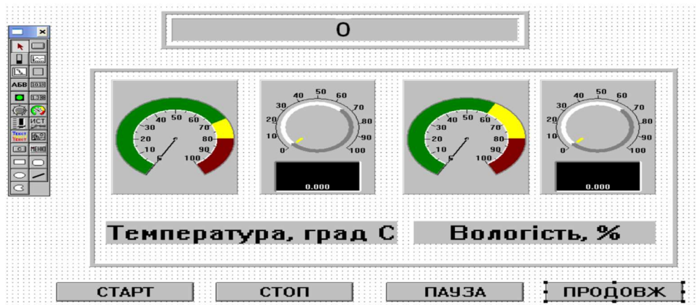
Рисунок 5.5 – Панель керування технологічним процесом вирощування шампінйонів в SCADA-системи ADAMView
