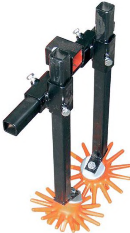
Рисунок 2.3 – Пальчиковий культиватор для обробітку міжряддя на профільній рамі
