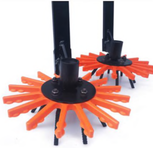
Рисунок 2.2 - Вигляд пальчикового культиватора з гнучкими робочими органами
