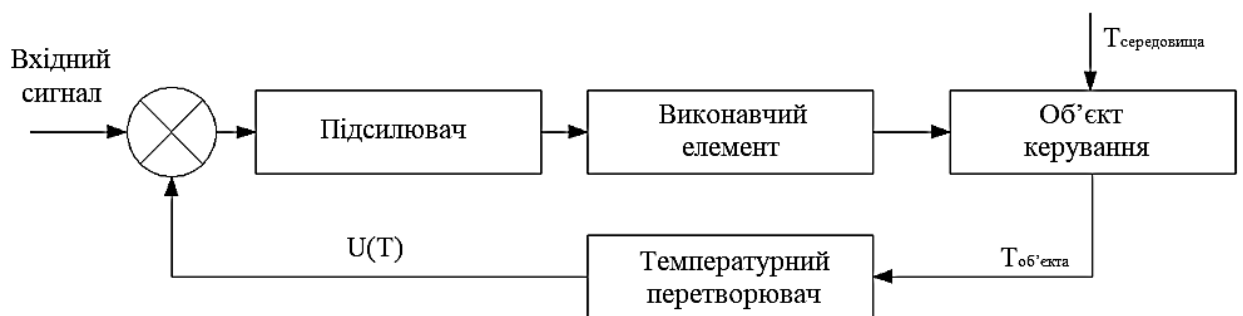
Рисунок 1.1 – Узагальнена схема термостатування зі зворотним зв'язком [3]
