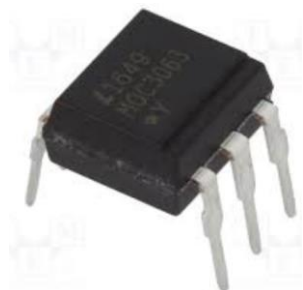
Рисунок 3.9 – Зовнішній вигляд (а) та розпіновка виводів опторозв’язки МOC3063 [19]
