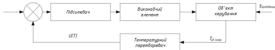
Рисунок 1 – Узагальнена схема термостатування зі зворотним зв'язком
